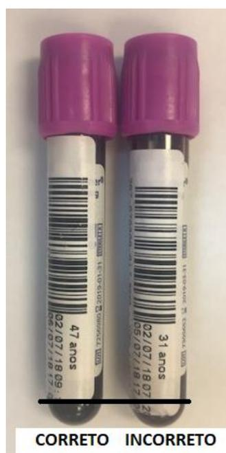
**Figura 08.** Etiquetas coladas na base do tubo e que geram acidentes no equipamento, pois enroscam na rack.
