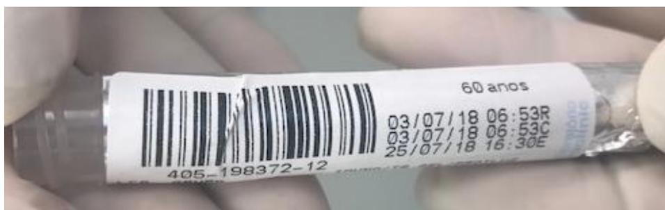
**Figura 06.** Etiqueta rasurada/borrada/falhada/apagada/enrugada causa erro na leitura do código de barras nos equipamentos. Impacto: necessário reetiquetagem podendo causar atraso ou perda de rastreabilidade.
