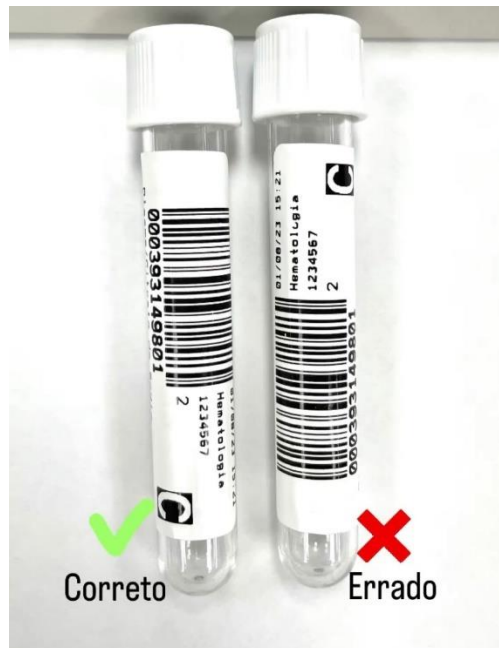
Figura 08. Etiquetas coladas na base do tubo e que geram acidentes no equipamento, pois enroscam na rack.
