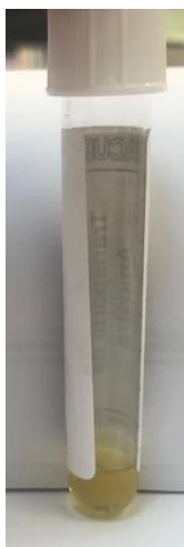
Figura 13. Tubo de transporte contendo um volume de soro de 500 uL. Tubo com um volume inferior a 500 uL pode não ser aspirador pelo equipamento devido a profundidade do tubo.
