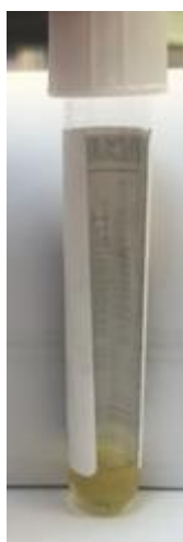
Figura 13. Tubo de transporte contendo um volume de soro de 500 uL. Tubo com um volume inferior a 500 uL pode não ser aspirado pelo equipamento devido a profundidade do tubo.
